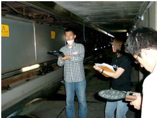
그림 3. 전동차 인버터 주변에서의 전자파 측정 모습.
