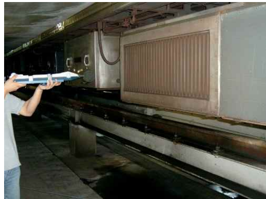
그림 3. 전동차 인버터 주변에서의 전자파 측정 모습.
